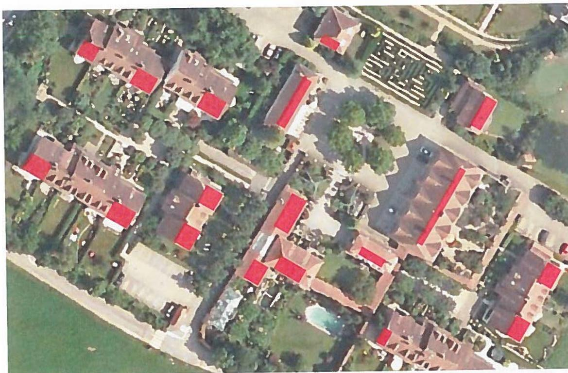
Abbildung 21: Dorfkern mit Dachflächen die für eine solarthermische Nutzung geeignet sind
